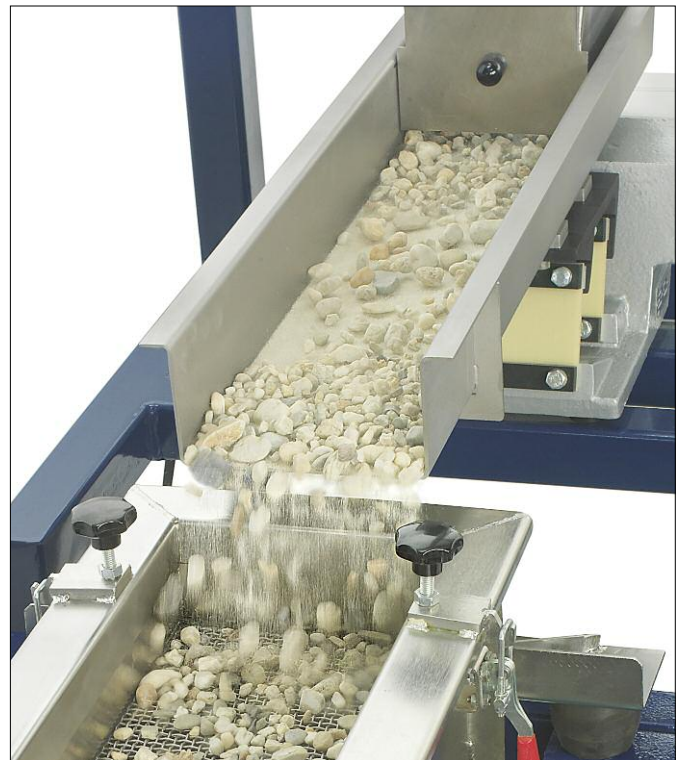
HAYER EMZ Förderrinne bei der Dosierung von Sand und Kies
