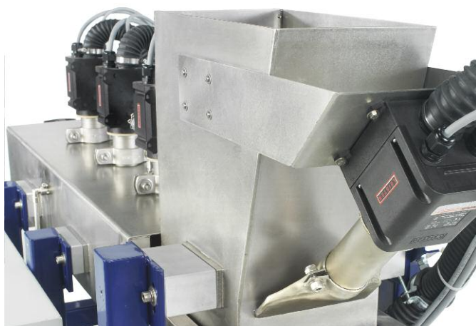
HAYER HSD® zum Trocknen von Körnungen nach der Nassaufbereitung
