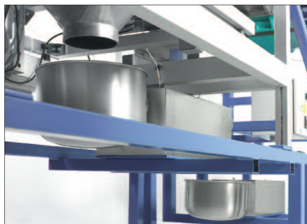
HAVER CPA 4 GRAVIOPT mit zwei Drehbehälterwaagen für den Siebunter- und Siebüberlauf
